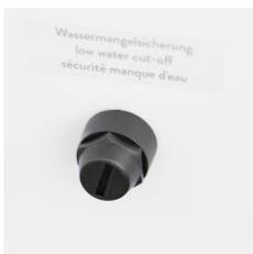
En caso de falta de agua, el limitador de temperatura apaga el equipo de destilación.
